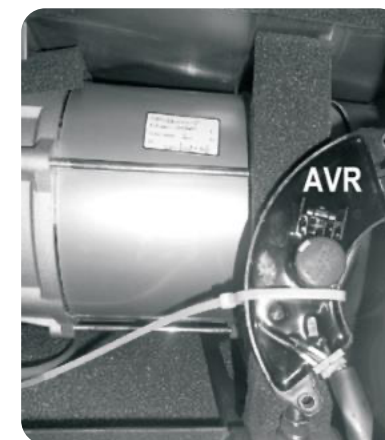
Figura B – Repase la ubicación del AVR (Regulador del voltaje automático en inglés). Este ítem pudiera eventualmente requerir reemplazo al desgastarse.
