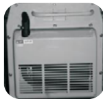
1. Remueva el panel de acceso del silenciador
