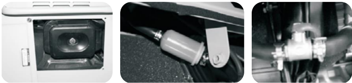
Figura 9 – Cambiando el filtro de aceite
