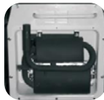
2. Remueva el sistema de silenciador dual
